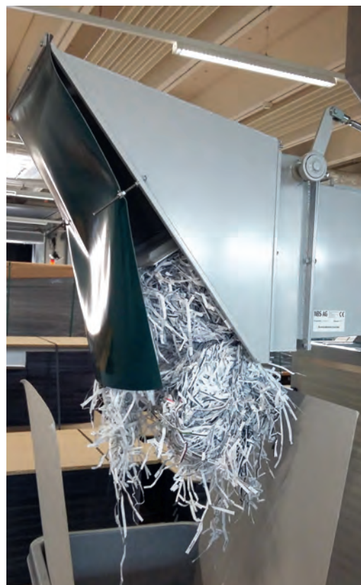
Papierabfall wird in einer Kompaktieranlage staubfrei in einem Verhältnis von 1:5 verdichtet.
