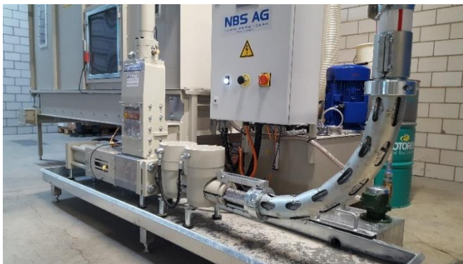
Abbildung 1: Brikettierpresse mit Emulsion
