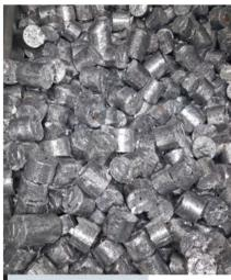
Aus den losen Aluminium-Abfällen werden stahlharte und wiederverwendbare Briketts gemacht.
